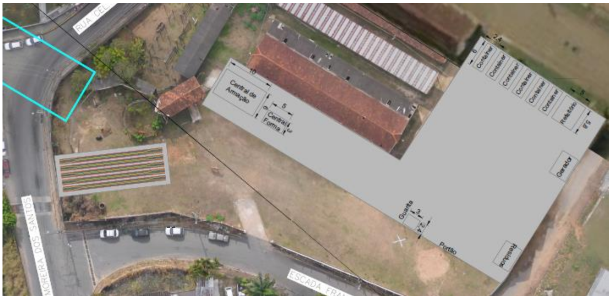
Figura 21 – Layout do Canteiro Principal do Viaduto
