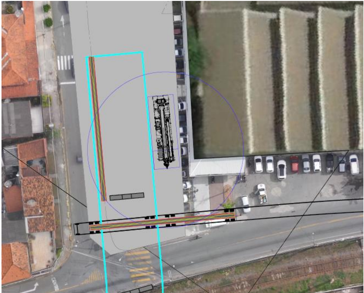
Figura 12 – Lançamento das Vigas – Vão Norte
